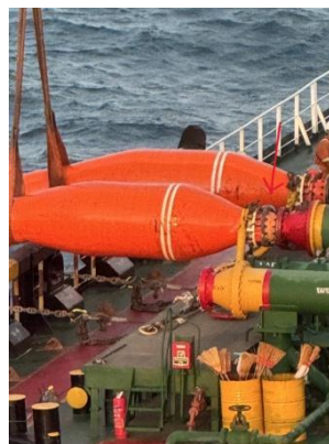
รูปที่ 3-30 วาล์วนิรภัยของระบบท่อขนส่ง
